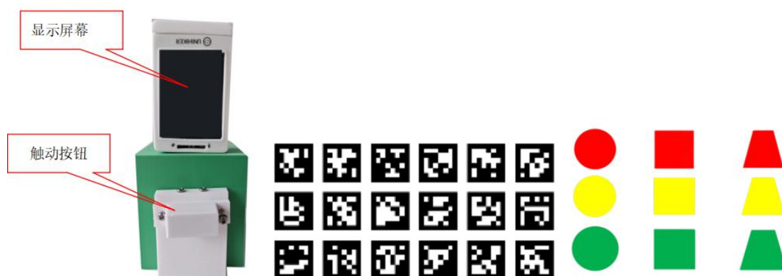
图 3 随机变换装置及其显示的“标签”或“物品”示意图
